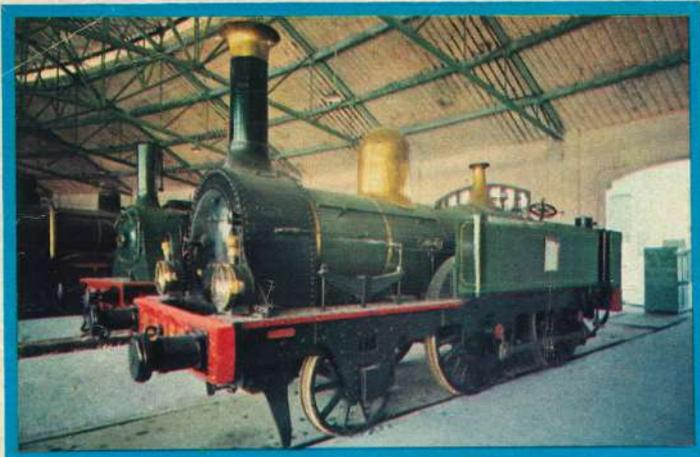
● **LOCOMOTORA 120-2.112 (Ex MZA 168).** Construida en el año 1854 por Sharp & Stewart, de Manchester (Inglaterra), para la Compañía del Ferrocarril de Barcelona a Martorell.
