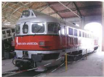
Locomotora 353-005 (3005 T) 1969 Krauss Maffei i Maybach-Mercedes Benz (Alemanya) 88.000 kg 2.206 kW 180 km/h
