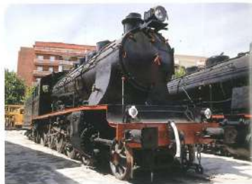
Locomotora 240-2047 (Central de Aragón 74) Tubize 1927 Tubize (Bélgica) 90.175 / 125.375 kg 1.350 CV (994 kW) 115 km/h
