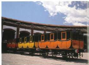
Cotxes de 1ª, 2ª i 3ª del Tren del Centenari 1948 La Maquinista Terrestre y Marítima (Barcelona) 6.300, 6.070 i 5.584 kg 24 + 24 + 30 places
