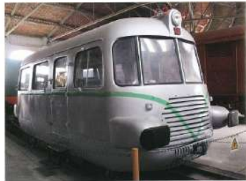
Dresina de vies i obres 1940 ca. Construcció artesanal Motor Alfa Romeo 1.600 cc.
