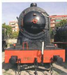
Locomotora 240-2135 (MZA 1155) Mastodonte 1913 Henschel (Alemania) 89.700 / 116.555 kg 1.755 CV (1292 kW) 60 km/h
