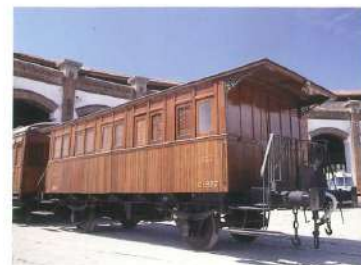
Cotxe MZA C-827 (Renfe C-2302) Tercera 1905 Material para Ferrocarriles y Construcciones 11.200 kg 9.970 m 50 places
