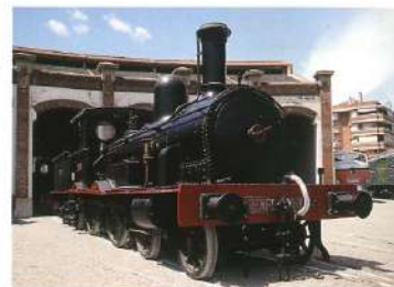
Locomotora 030-2471 (Central de Aragón 1) 1902 Marcinellid Couillet (Bélgica) 49.000 / 65.500 kg 960 CV (707 kW) 80 km
