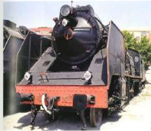
Locomotora 240F-2705 (Renfe 2705) Renfe 1951 Devis (Valencia) 131.000 / 184.200 kg 3.100 CV (2.262 kW) 105 / 115 km/h
