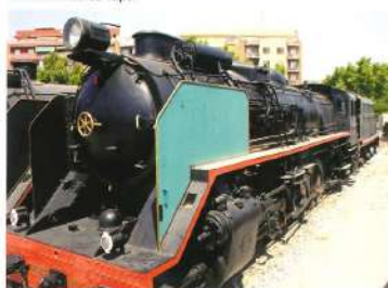
Locomotora 141F-2348 (Renfe 2348) Mikado 1957 La Maquinista Terrestre y Marítima (Barcelona) 119.500 / 166.500 kg 2.000 CV (1.742 kW) 90 / 115 km/h
