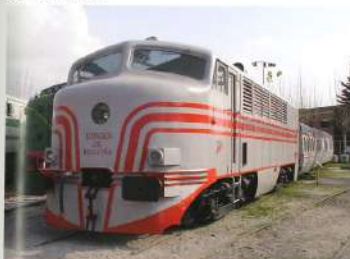
Locomotora 350-003 (3 T) i 4 cotxes Talgo II 1960 American Car Foundry i Wilmington (EUA) 66.000 kg (locomotora) 596 kW 140 km/h
