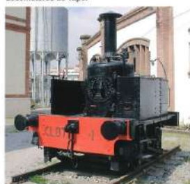
Locomotora 020-0210 (Alcañiz - Puebla de Híjar 4) Teresita 1885 Société Anonyme Cockorill (Bélgica) 7.000 / 8.000 kg 152 CV (111 kW)
