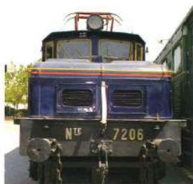
Locomotora 272-006 (Norte i Renfe 7206) Cocodril 1928 Babcock & Wilcox (Espanya), Brown Boveri i Oerlikon (Suïssa) 145.000 kg 2.100 kW 110 km/h
