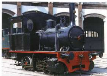
Locomotora 020-04 (Andalucés 4) Andalucés 1871 Société Anonyme Cockerill (Bèlgica) -- / 39.300 kg 630 CV (463 kW) 50 km/h
