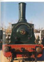
Locomotora 120-2131 (Oeste 77) 1884 Maschinen Fabrik (Esslingen, Alemanya) 45.500 / 62.950 kg 650 CV (478 kW) 60 km/h
