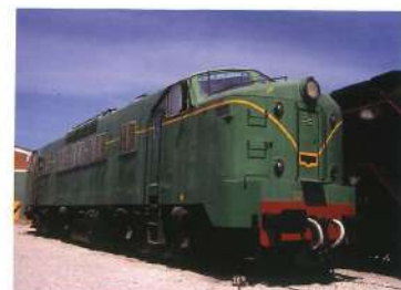
Locomotora 278-007 (Renfe 7807) Panchorga 1964 Westinghouse (EUA) 120.000 kg 2.200 kW 110 km/h
