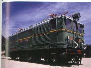
Locomotora 280-004 (Estat i Renfe 1004) 1929 CAF (Espanya) i Tarbes (França) 74.800 kg 736 kW 75 km/h
