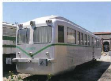
Automotor 590-165 (Norte i Renfe 9165) 1935 Material Móvil y Construcciones (Zaragoza) 16.000 kg 110 kW 100 km/h
