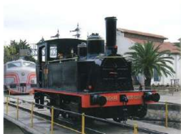
Locomotora 020-0236 (MZA 606) 1885 Marcinellid Couillet (Bélgica) 14.920 / 19.350 kg 288 CV (211 kW)
