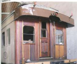
Cotxe MZA BWFFV 8 (Renfe BB 2597) Harlan 1878 Harlan & Hollingsworth Co. (EUA) 20.440 kg 16.250 m 58 places
