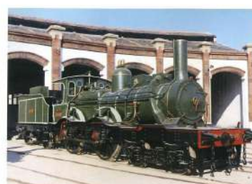
Locomotora 220-2005 (Oeste 9) 1881 Rich Hartmann (Chemnitz, Alemanya) 47.550 / 65.800 kg 739 CV (544 kW) 90 km/h
