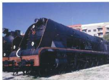
Locomotora 241F-2108 (MZA 1808) Linda Tapada 1939 La Maquinista Terrestre y Marítima (Barcelona) 143.100 / 193.100 kg 3.170 CV (2.333 kW) 115 / 130 km/h
