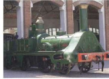
Locomotora 1-1-1 Mataró 1948 La Maquinista Terrestre y Marítima (Barcelona) 30.100 / 34.700 kg 50 / 80 km/h
