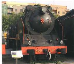
Locomotora 151F-3101 (Renfe 5001) Santa Fe 1942 La Maquinista Terrestre y Marítima (Barcelona) 163.160 / 213.160 kg 3.960 CV (2.915 kW) 90 / 100 km/h
