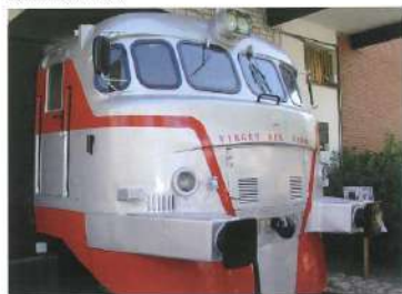
Cabina de locomotora 352-005 (2005 T) Talgo III 1964 Krauss Maffei i Maybach-Mercedes Benz (Alemanya) 76.000 kg 1.470 kW 160 km/h
