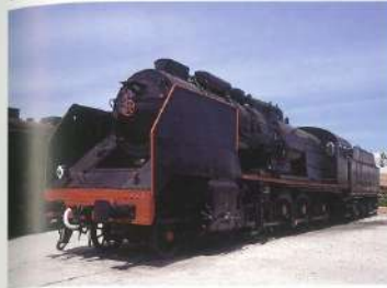
Locomotora 240F-2591 (Renfe 2591) Renfe 1946 Euskalduna (Bilbao) 131.000 / 184.200 kg 3.100 CV (2.262 kW) 105 / 115 km/h
