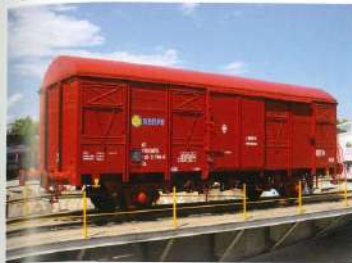
Vagó J2 402.915, Sèrie internac. GS 1974 La Maquinista Terrestre y Marítima (Barcelona) 12.500 / 27.500 kg 100 km/h
