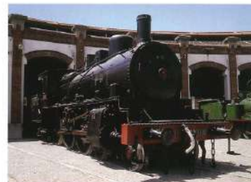
Locomotora 230-2085 (Norte 3101) Norie 1909 Hanomag (Alemanya) 74.700 / 100.100 kg 1.197 CV (881 kW) 100 km
