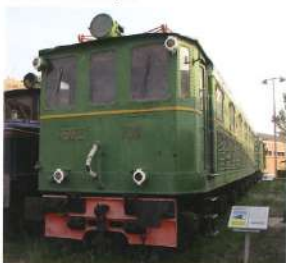
Locomotora 270-001 (Norte i Renfe 7001) Chata 1928 Euskalduna (Bilbao) i Oerlikon (Suïssa) 102.000 kg 1.325 kW 90 km/h
