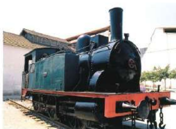
Locomotora 030-0233 (Mollet - Caldes 6) Caldes 1887 La Maquinista Terrestre y Marítima (Barcelona) 32.500 / 39.300 kg 432 CV (318 kW) 50 km/h
