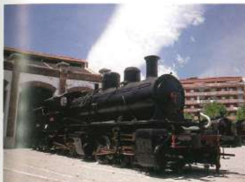
Locomotora 060-4013 (Central de Aragón 53) Mallat 1905 SLM Winterthur (Suïssa) 77.200 / 102.900 kg 950 CV (698 kW) 60 km/h
