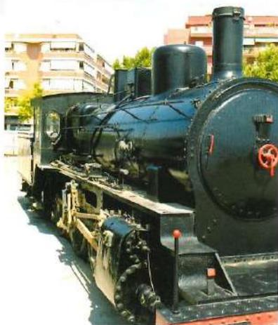
Este modelo de locomotora alemana representó, por diseño, potencia y velocidad, una gran renovación de la tracción a vapor a principios del siglo XX. Por su potencia y disposición de ejes 2-3-0 Tenwheeler, la sólida *Compañía del Norte* les encomienda la tracción de sus trenes rápidos hasta mitad de la década de los años 20, en que fueron sustituidas por las *Montaña 4600*.
