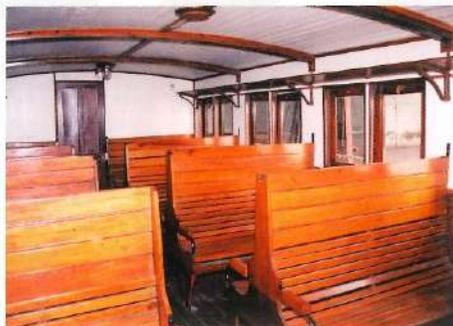
El coche de madera de tercera clase muestra el confort existente en la época. No dispone de bogies, sino de ejes simples, con lo que eso comporta: escasa velocidad y deficiente suspensión, además, está claro, de sus asientos de madera.
