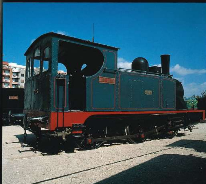
Locomotora Caldes, de 1887, característica dels primers ferrocarrils de Catalunya, que va circular per Barcelona ciutat i per la comarca del Vallès fins a mitjans de segle.
