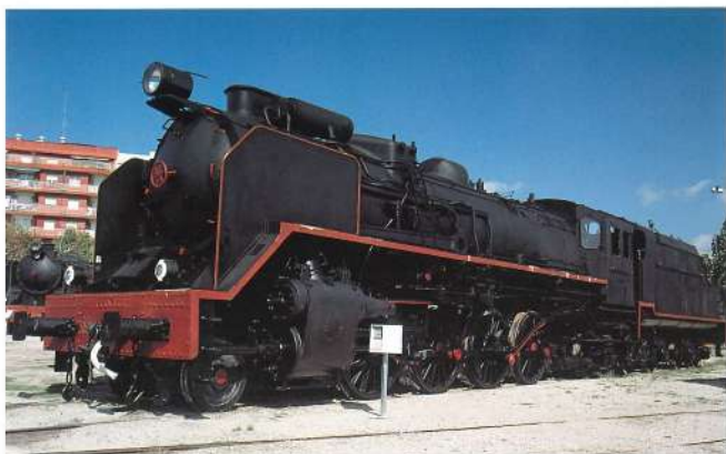
Primera de les dues locomotores Mikado del Museu. Aquesta va ser construïda per funcionar amb carbó, però després es transformà per al fuel. La segona ja es construí només per a fuel.
